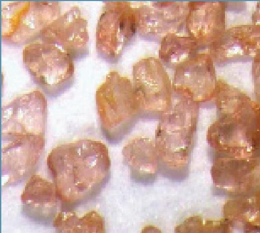
Абразив качества **BEACH** это продукт, который добывается из морского песка, и по этой причине имеет закругленные грани, которыми характеризуются все камни и булыжники, подверженные действию потоков морской воды.
