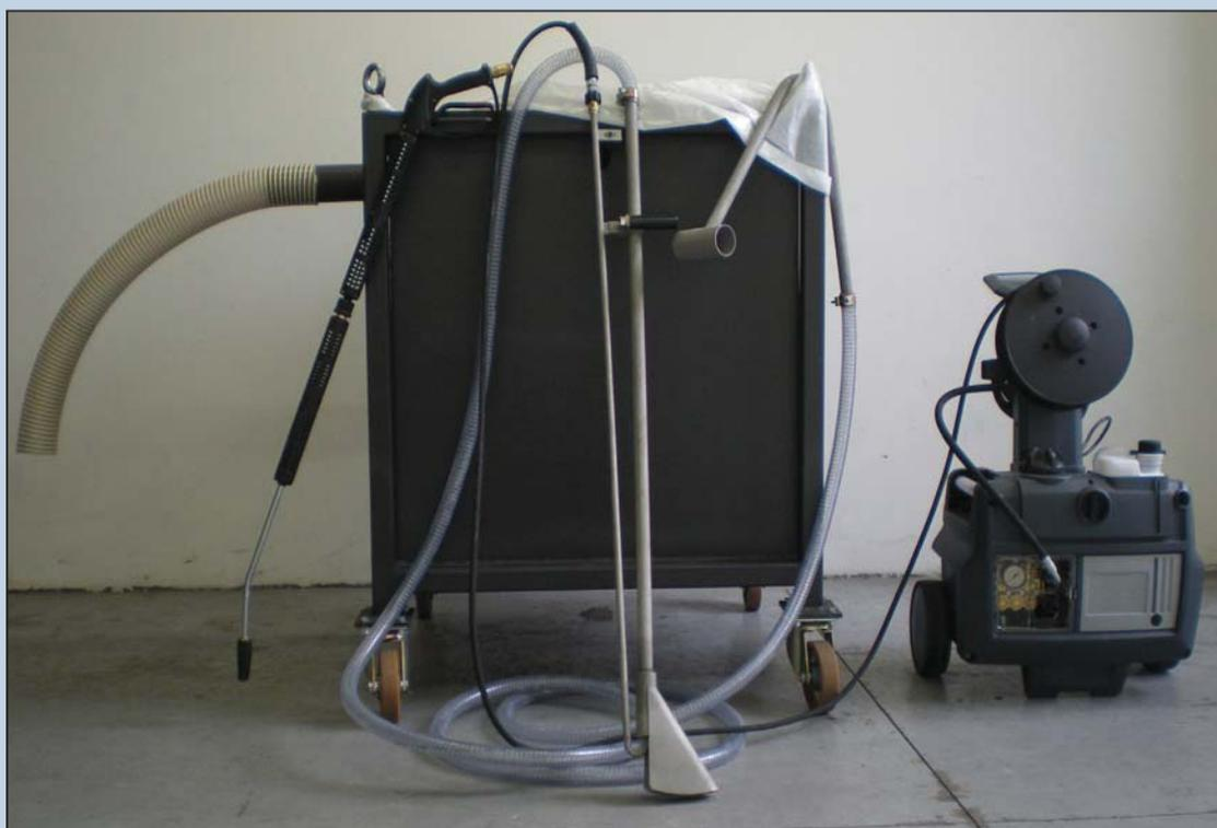
2. Tubo ad alta pressione di collegamento mediante attacco rapido, tra la lancia e la pompa.
