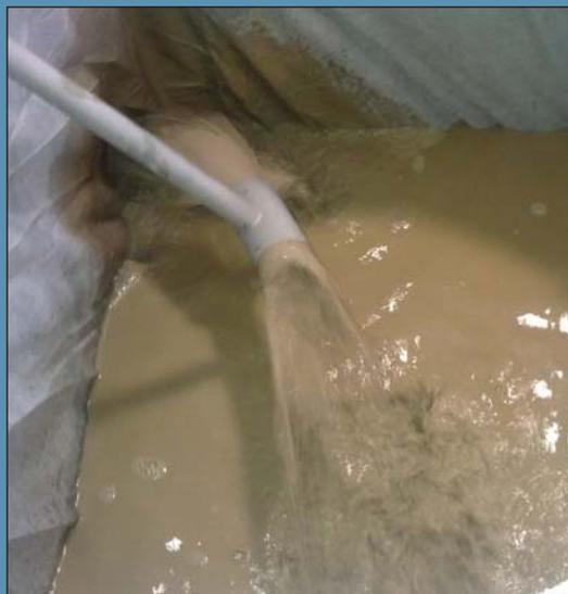
L'estrattore manuale dei fanghi ha la funzione di pulire la vasca manualmente senza dover fermare la macchina od usare mezzi esterni e costosi per tale lavoro.
